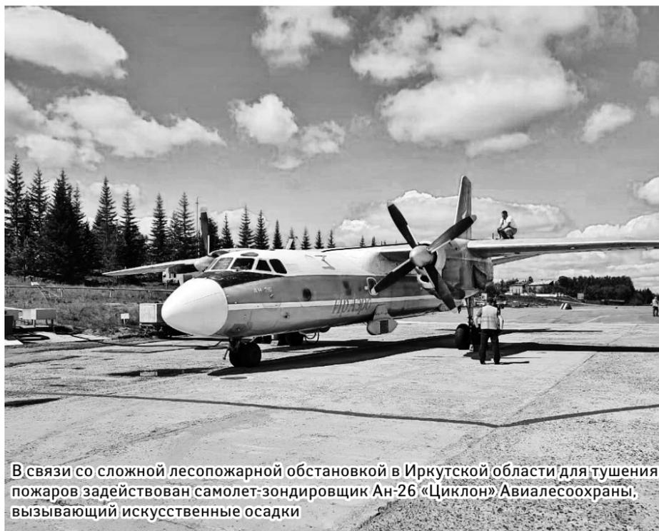
В связи со сложной лесопожарной обстановкой в Иркутской области для тушения пожаров задействован самолет-зондировщик Ан-26 «Циклон» Авиалесоохраны, вызывающий искусственные осадки
