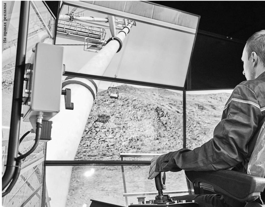
Тренажер полностью повторяет кабину ЭШ 20/90 и его систему управления. Круговые экраны создают эффект дополненной реальности и воспроизводят процесс с высокой точностью, имитируя движение техники при проведении вскрышных работ или шагания экскаватора.
