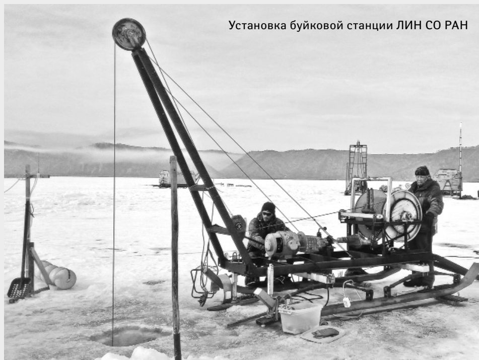
Строительство пункта мониторинга на полигоне «Бугульдейка»
