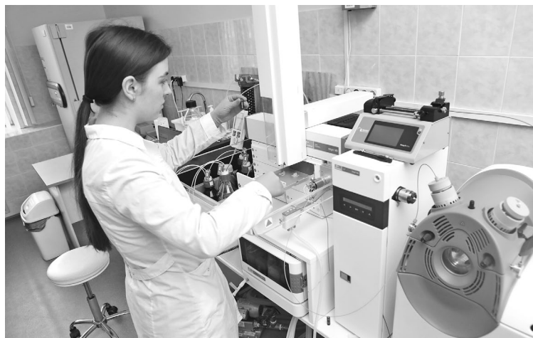
Высокоэффективный жидкостный хроматограф быстро диагностирует 29 редких заболеваний
