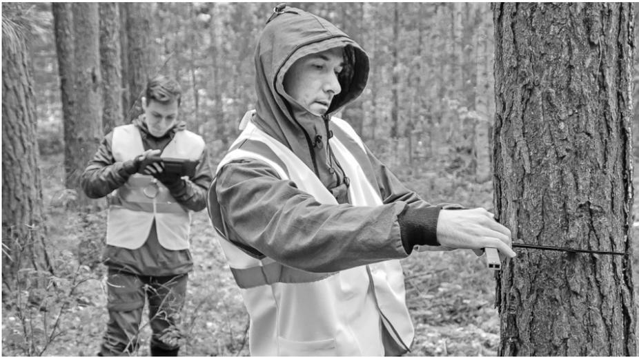
Михаил Елисеев и Василий Лазукин проводят дополнительные измерения. После составления ортофотоплана программа отмечает деревья, с определением которых из-за плотного древостоя возникли трудности. Эти данные вносятся «с земли» с помощью планшета. Заодно специалисты проводят выборочные замеры и сверку с данными, полученными с воздуха.
