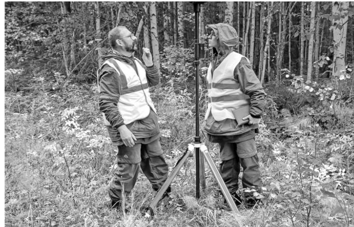
Трекер позволяет определять и фиксировать на метаслой цифровой фотографии координаты отдельного дерева с точностью до 2–3 см
