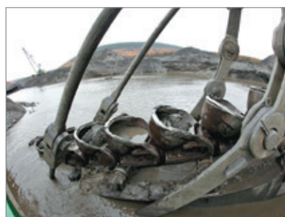
Драга № 601 (крупнейшая в мире речная черпаковая драга для золотодобычи, эксплуатировавшаяся на Мараканской золотой россыпи с 1969 по 1992 год)
