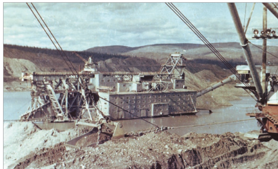
Драга № 601 (крупнейшая в мире речная черпаковая драга для золотодобычи, эксплуатировавшаяся на Мараканской золотой россыпи с 1969 по 1992 год)
