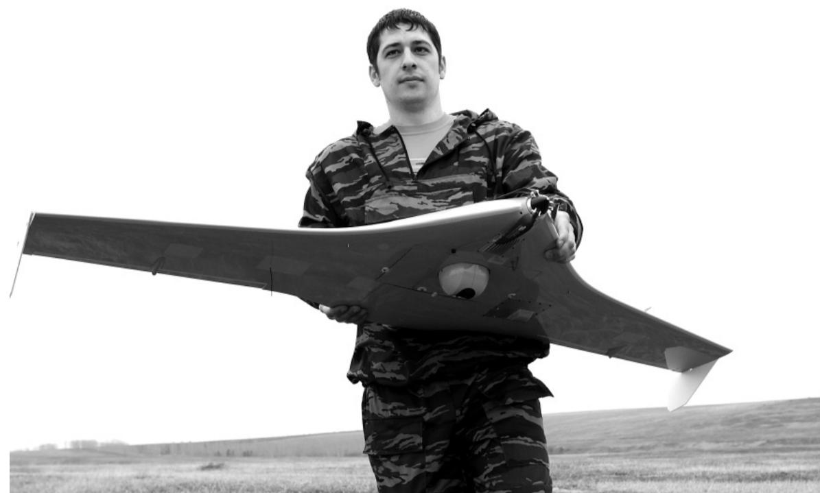
**Беспилотный летательный аппарат, оснащенный системами фото- и видеонаблюдения, изучает территорию в радиусе 15–20 км и передает изображение на пульт управления. Заметить в воздухе прибор, больше похожий на игрушку, очень сложно – электродвигатель работает практически бесшумно.**
