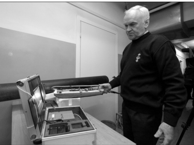
Прибор для диагностики состояния трубопроводов разработан сотрудниками ЗАО НПО «Восток-тор»
