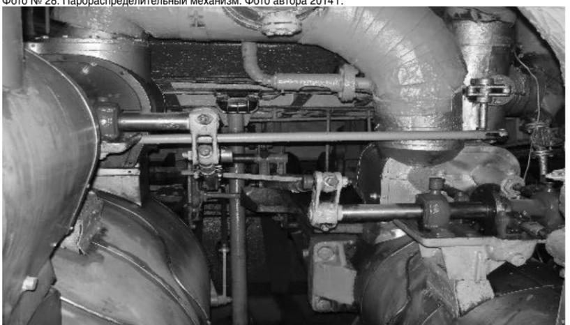
Фото № 29. Парораспределительный механизм, а слева и справа цилиндры низкого и высокого давления паровой машины. Фото автора 2014 г.
