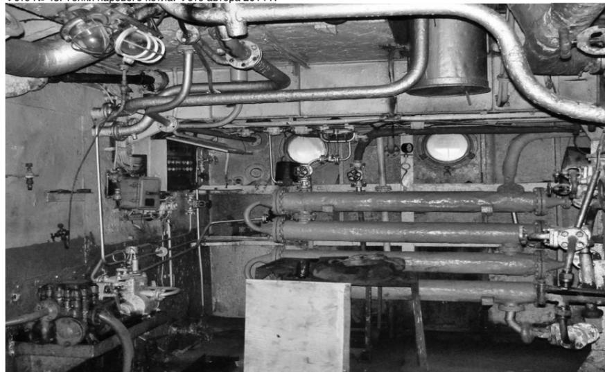
Фото № 44. Котельное отделение, слева топливная донка. Прямо – теплообменник подогрева мазута. Фото автора 2014 г.
