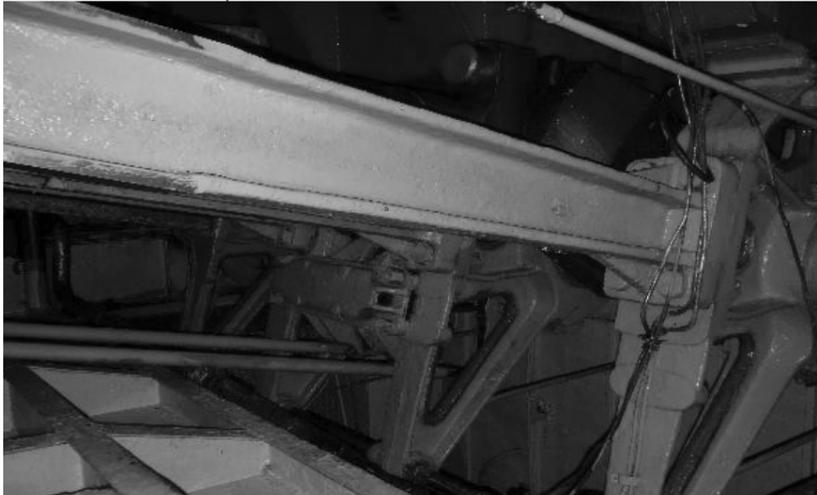
Фото № 26. Рама паровой машины с гребным валом. Фото автора 2014 г.
