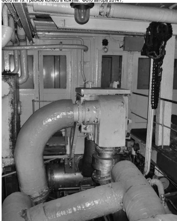
Фото № 20. Паропроводы к цилиндрам высокого и низкого давления, машинное отделение по главной палубе.
