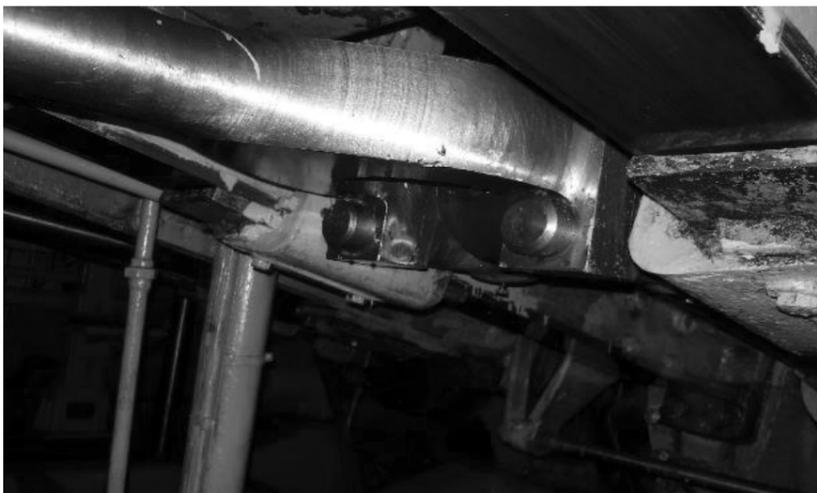
Фото № 27. Рама, ползун, шток. Крейцкопф – кривошипно-ползунный механизм, совершающий возвратно-поступательное движение по неподвижным направляющим. Фото автора 2014 г.
