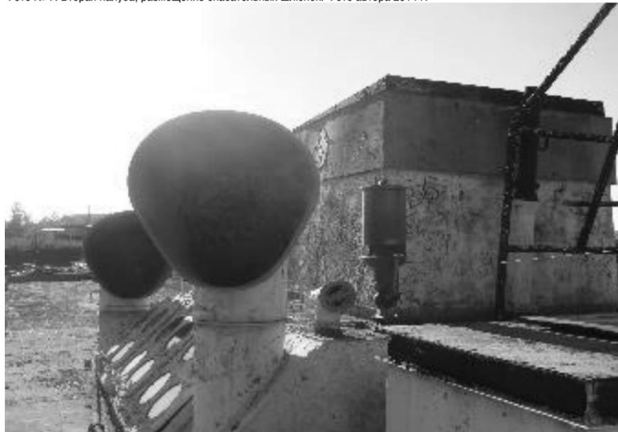
Фото № 8. Дымовая труба. Слева и справа от трубы паровые гудки. Светлые люки котельного отделения на верхней палубе. Фото автора 2014 г.
