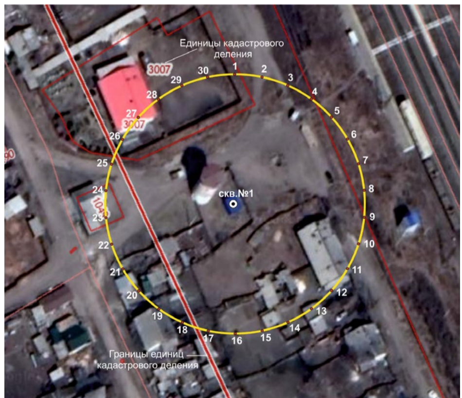
Второй пояс зоны санитарной охраны водозаборной скважины 1 станции Забитуй ВСЖД ОАО «РЖД»
