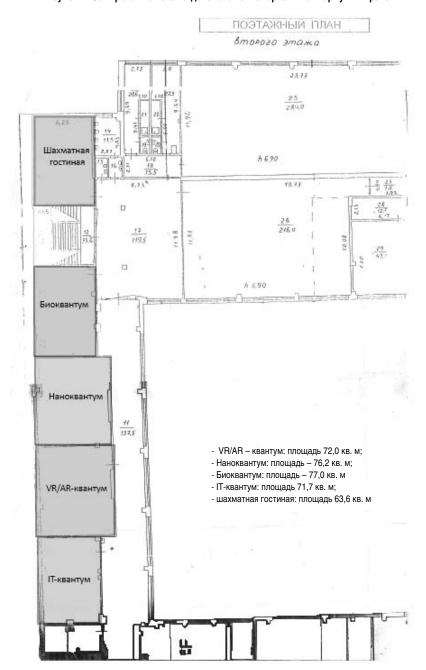
Рисунок 2. Зонирование II этажа детского технопарка «Кванториум» г. Братск Биоквантум
