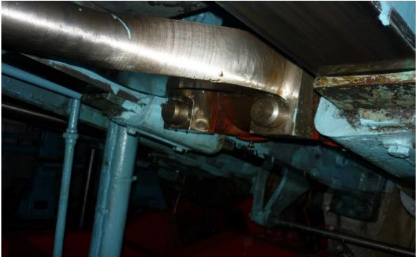
ПРИЛОЖЕНИЕ 2. ФОТОФИКСАЦИЯ. Фото № 27. Рама, ползун, шток. Крейцкопф – кривошипно-ползунный механизм, совершающий возвратно-поступательное движение по неподвижным направляющим. Фото А.А. Жильцов.
