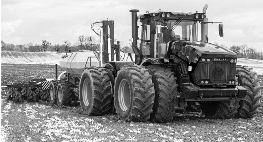
На «Кировец» К-7М устанавливаются как российские, так и зарубежные двигатели мощностью от 300 до 428 лошадиных сил. Новая автоматизированная коробка перемены передач «Т7» значительно модернизирована и автоматизирована и обеспечивает более надежную работу.
