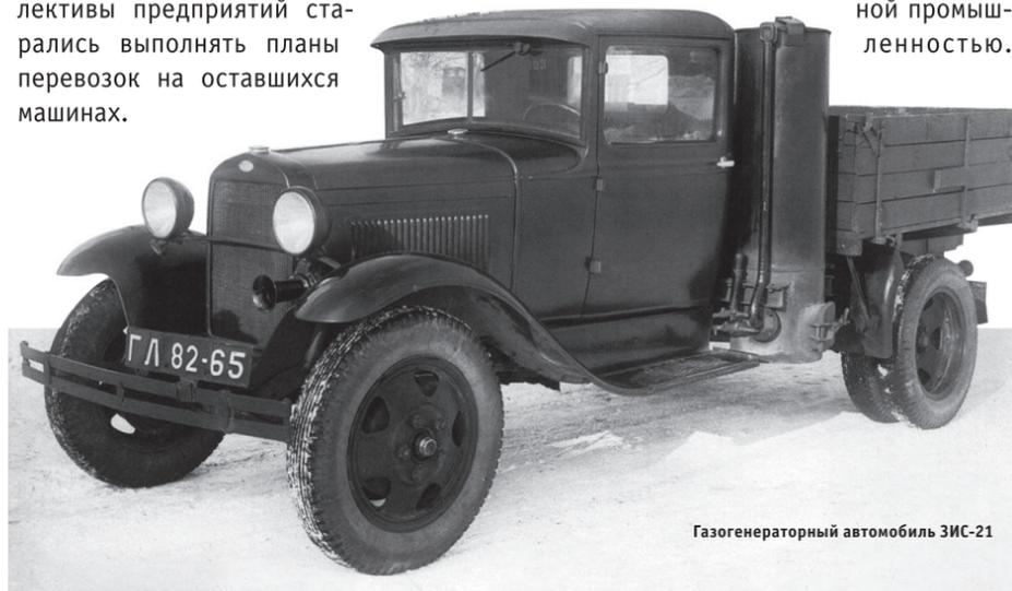
Газогенераторный автомобиль ЗИС-21
