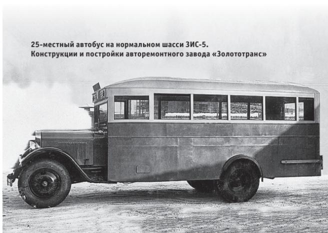
25-местный автобус на нормальном шасси ЗИС-5. Конструкции и постройки авторемонтного завода «Золототранс»
